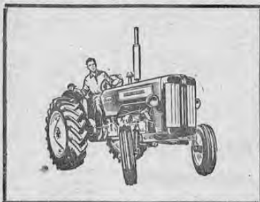
Modelo B-414 con Motor Diesel de 40 caballos Llantas 600 x 16 y 12 x 28
